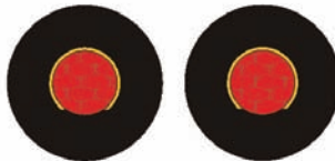
Semáforos especiales Para cruce ferroviario
