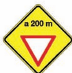
Proximidad de Señal Restrictiva (Paso) P 33
