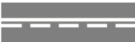
Indica la división de carriles de un mismo sentido de circulación, permite cambiar de carril del lado de la línea discontinua y prohíbe el cambio de carril la línea discontinua.
