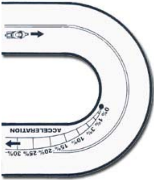
Figura 5.9. FASE IV: La aceleración suave y progresiva, conforme se va levantando la moto de la tumbada, en la salida de la curva, evita que la rueda trasera derrape (Según Nick Ienatsch 5 ).
