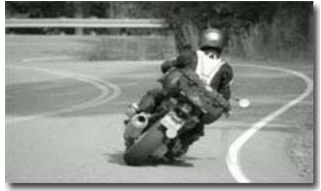
Figura 5.39: Postura en la tumbada inglesa: el tronco del piloto queda más vertical que la inclinación de la moto.
