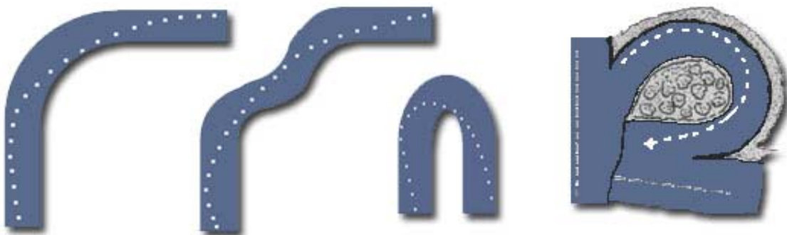
Figura 5.10: Trazados en distintos tipos de curvas (solo está representado el carril por el que se circula).
