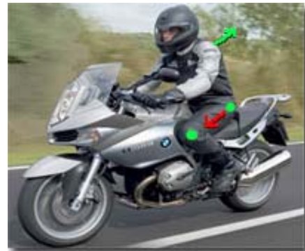
Figura 4.4: Durante la frenada, la presión sobre las rodillas, contiene la inercia del piloto, y permite incorporarse de la moto, sin cargar de peso el manillar.
