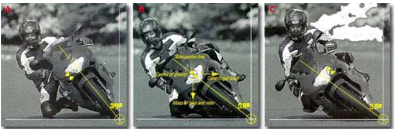
Figura 5.38: Estas fotografías muestran como el traslado lateral del peso del piloto modifica el centro de gravedad del conjunto piloto-máquina y su repercusión sobre el grado de tumbada –para una misma curva y velocidad-. En el centro (B), la postura continental (52°). A la izquierda (A), la postura racing (39°) y a la derecha (C), la postura inglesa (55°).
