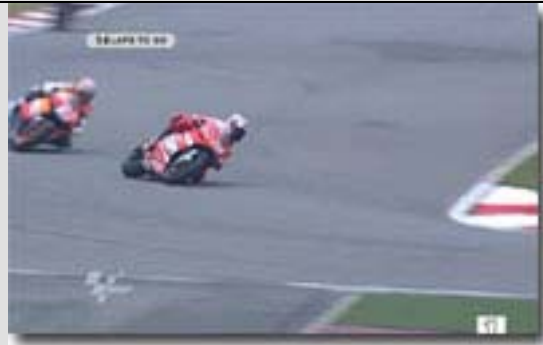
Figura 5.5. FASE III: Stoner inicia un punto de gas pese a que aún no ha llegado al ápex de la curva, pero sí a la máxima inclinación de la moto para este giro.
