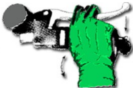
Figura 3.6 . Golpe de gas al vacío al tiempo que se frena con la maneta. El giro brusco de la muñeca se realiza sin modificar la presión de los dedos sobre el mando del freno. (Dibujo modificado de K. Code 4 ).
