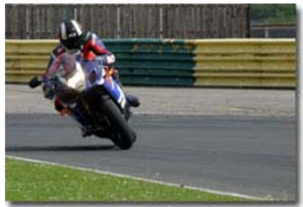
Figura 5.39: Timoneo. El derrape de la rueda trasera se controla con el gas, manejando el desplazamiento lateral del peso para mantener el equilibrio y respetando el contramanillar espontáneo de la moto.
