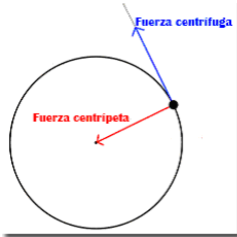
Figura 1.14: La fuerza centrífuga siempre tiende a que la moto se levante de la tumbada y continúe en línea recta.
