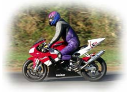
Figura 4.1: Al accionar la maneta del freno, la moto comprime el amortiguador delantero al tiempo que descomprime el trasero, debido al traslado de peso que provoca hacia el tren anterior.
