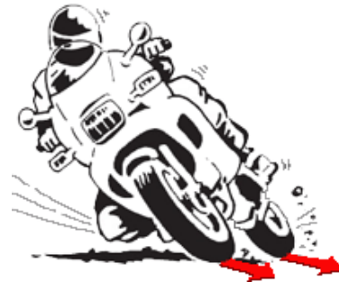
Figura 4.7: Durante el paso por curva, los neumáticos sufren una fuerte carga lateral, que alcanza su máxima expresión cuando la moto está en plena tumbada.
