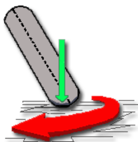
Figura 4.9: La asimetría de la carga sobre el neumático, y la retención que realiza el freno sobre la rueda, provocan un giro del manillar en el sentido del giro, lo que en realidad representa un contramanillar que levanta la moto de la tumbada.
