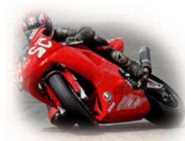
Figura 7.2: El contramanillar hacia el mismo lado que el derrape, es una reacción espontánea de la moto cuando el tren posterior desliza hacia un lado.
