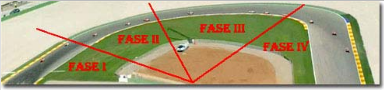
Figura 5.1: División de una curva en función de las fases de las maniobras. FASE I: Valoración de la curva, establecimiento del punto de tumbada, reducción de velocidad y de marchas. FASE II: Gas cerrado. El motor ayuda a contener la moto y afina la velocidad para la siguiente fase. FASE III: Un punto de gas. En esta composición el ápice de la curva es muy largo. Lo frecuente es que sea corto, por lo que esta fase suele durar solo unos metros. FASE IV: Aceleración progresiva desde el ápice hasta la salida de la curva.
