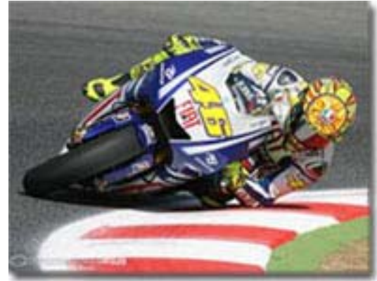
Figura 5.22: La rueda de Rossi ha girado ligeramente hacia el interior de la curva cuando se está acercando al ápice. Esta reacción suele ser espontánea en la moto.
