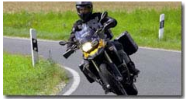
Figura 5.36: Postura continental. La distribución de pesos hacia ambos lados de la moto es simétrica. La cabeza mantiene una orientación lo más próxima a la vertical, como en las demás posturas.
