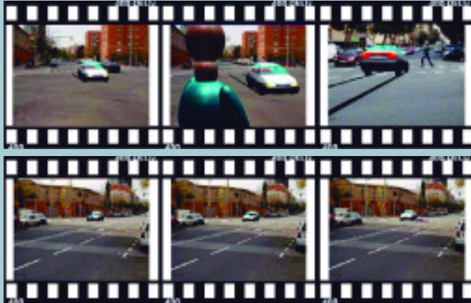
Simulación virtual de un accidente en la ciudad de Barcelona (la velocidad de circulación del vehículo antes de frenar es 57 km/h, y la velocidad final en el momento del impacto 27 km/h)
