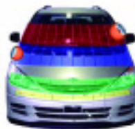
Instalaciones para la realización de ensayos de evaluación de la protección de peatones (EuroNCAP – Directiva 2003/102/CE).
