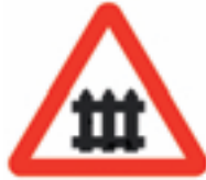
paso a nivel con barreras
