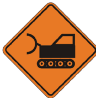
Equipo Pesado en la Vía T 7
