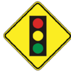
Proximidad de Semáforo P 32
