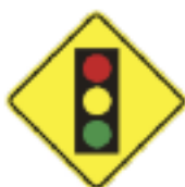
Proximidad de Semáforo
