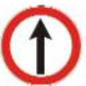
Sentido de circulación (Comienzo Sentido Único)
