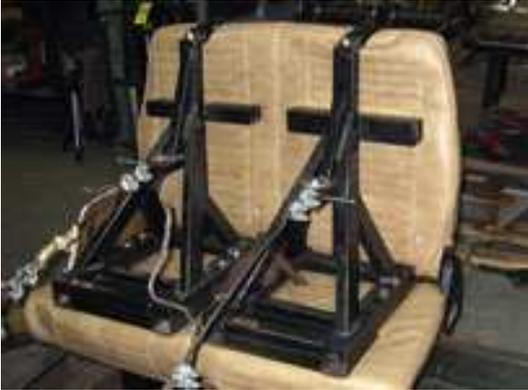
Prueba realizada sobre el tether, o correa de sujeción superior: Se aplica una precarga fuerza de 500 N (112 libras) en el punto X del dispositivo de prueba. Se aumenta la fuerza de tracción como de forma lineal como sea posible para una aplicación de fuerza de 15000 N (3,372 libras) en no menos de 24 segundos y no más de 30 segundos y se mantiene la fuerza durante 1 segundo.
