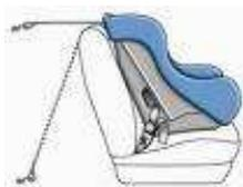
Existe un sistema de anclaje que es utilizado en el norte de América por Estados Unidos y Canadá: Ambos sistemas son similares y hacen una fácil instalación de la Butaca al vehículo, por un lado, Universal Anchorage System (UAS), es decir sistema de anclaje
