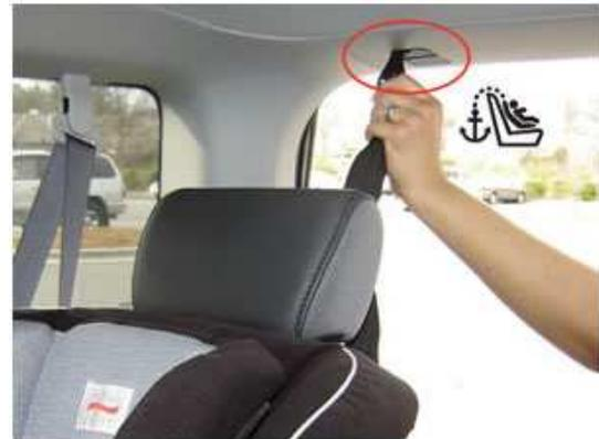
Cuando se trata de las butacas 0 ó 0+ que se colocan mirando en sentido contrario al de circulación, es recomendable NO utilizar el anclaje superior ya que no se encuentra diseñado este sistema para ese fin, Será entonces suficiente con el anclaje sobre la parte inferior proporcionando la misma seguridad.
