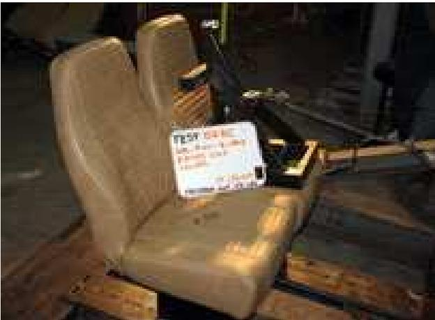
Se conecta el SFAD 2 a los dos anclajes inferiores del sistema de retención infantil. Se aplica una fuerza de precarga de 112 libras a  $10^\circ \pm 5^\circ$  por encima del plano horizontal con una X el punto del dispositivo de prueba. La fuerza se aumenta a 2.472 libras en no menos de 24 segundos y no más de 30 segundos y se mantiene la fuerza durante 1 segundo.
