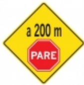
PROXIMIDAD DE SEÑAL RESTRICTIVA (pare)
