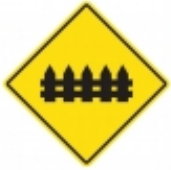
PASO A NIVEL CON BARRERAS
