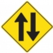
INICIO DE DOBLE CIRCULACION
