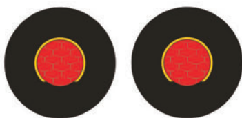
Semáforos especiales Para cruce ferroviario
