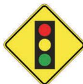
Proximidad de Semáforo P 32
