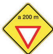
Proximidad de Señal Restrictiva (Paso) P 33
