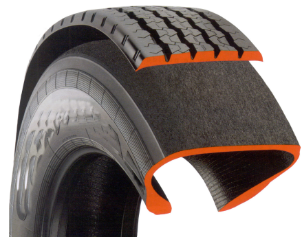
Fig. 8-17 Aplicación de una nueva banda
