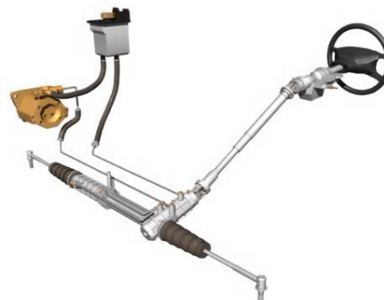
Fig. 9-6 Conjunto del sistema de dirección
