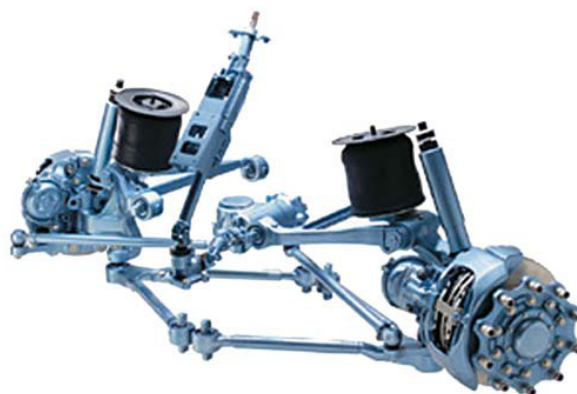
Fig. 9-3 Conjunto del sistema de suspensión
