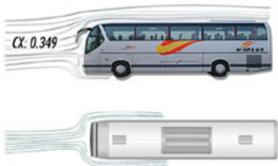
Fig. 1-12 Cálculo del coeficiente C_x
