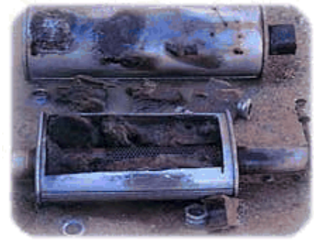
Fig. 4-10 Fusión del interior del catalizador
