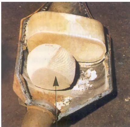
Fig. 4-11 Desgaste y rotura del catalizador
