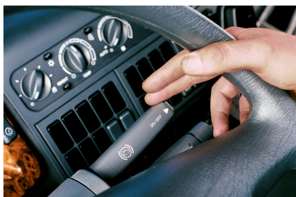
Fig. 10-15 Accionamiento del ralentizador
