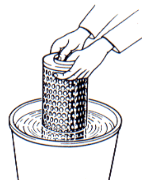
Fig. 3-5 Limpieza del elemento filtrante
