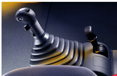
Fig. 7-19 Palanca para el grupo antepuesto y pospuesto
